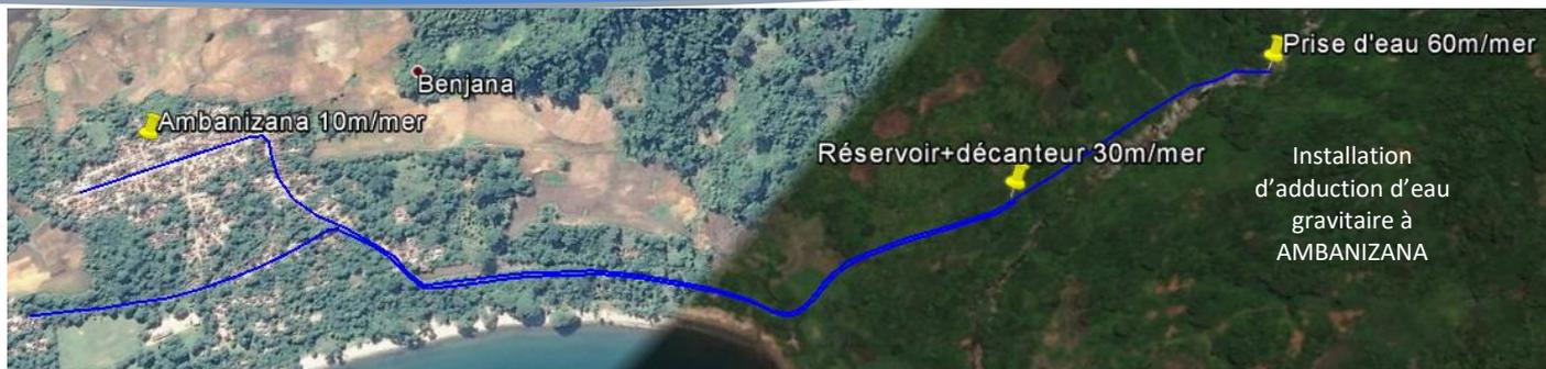
Réalisation sur une dérivation du torrent à une altitude de 60m/mer de 2 prises d'eau en génie civil avec grilles destinées à l'adduction d'eau du village et la conduite forcée de la turbine de 20kW prévue en 2017.
